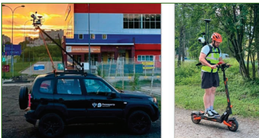
Рис. 3 Пример использования комплекса для МЛС с алгоритмом SLAM, установленного на автомобиле и закрепленного на рюкзаке
