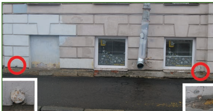
Рис. 17 Пункт современной полигонометрии на двух реперах. Красными кружками на фото обозначено местоположение репера и болванки (фото А.С. Богданова, 2022 г.)
