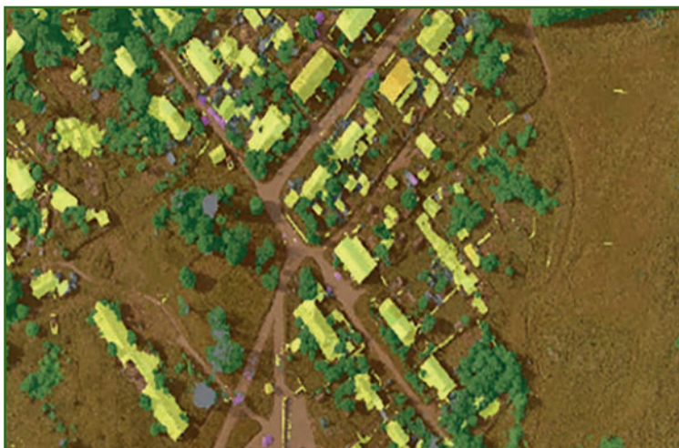
Рис. 2 Результат классификации фотограмметрического облака точек — съемка с БПЛА (Подмосковье)
