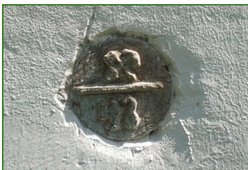
Нивелирная марка КОПС в стене Николо-Бабаевского монастыря, Большие Соли
