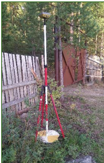
Рис. 2 Геодезические измерения на маркированных опознавательных знаках
