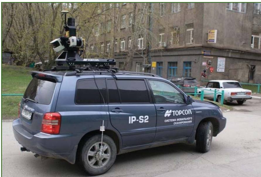
Рис. 3 Система мобильного сканирования TOPCON IP-S2
