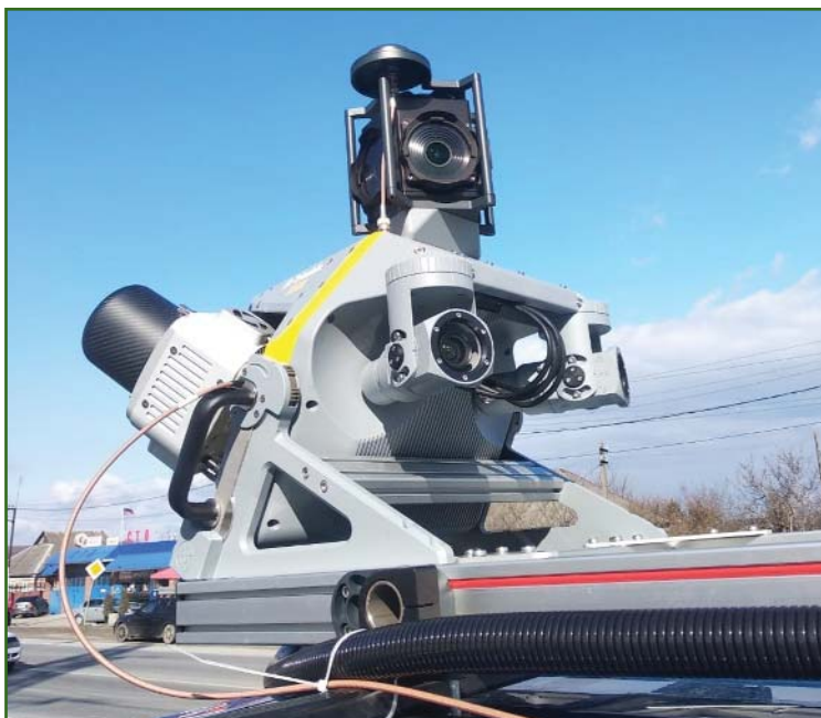
Рис. 2 Общий вид системы Trimble MX9 со стороны боковых цифровых камер
