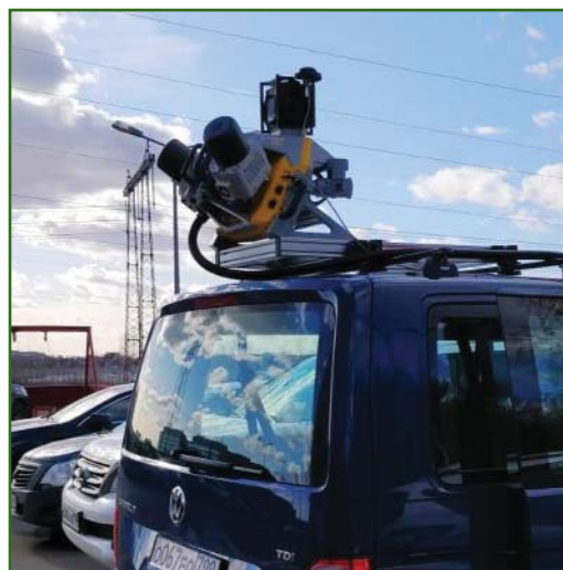
Рис. 3 Система Trimble MX9, установленная на крыше автомобиля
