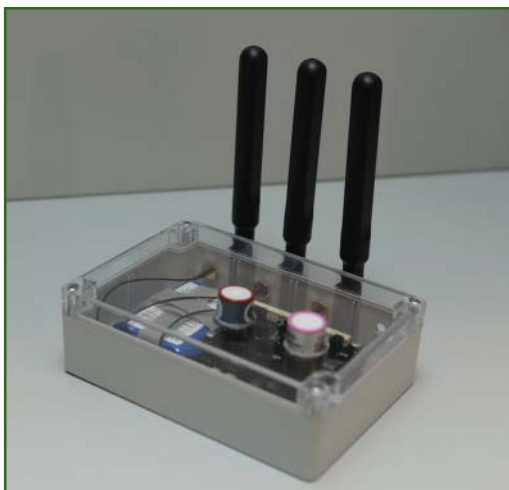
Рис. 1 Общий вид геосенсора для измерения уровня диоксида азота и монооксида углерода в атмосферном воздухе
