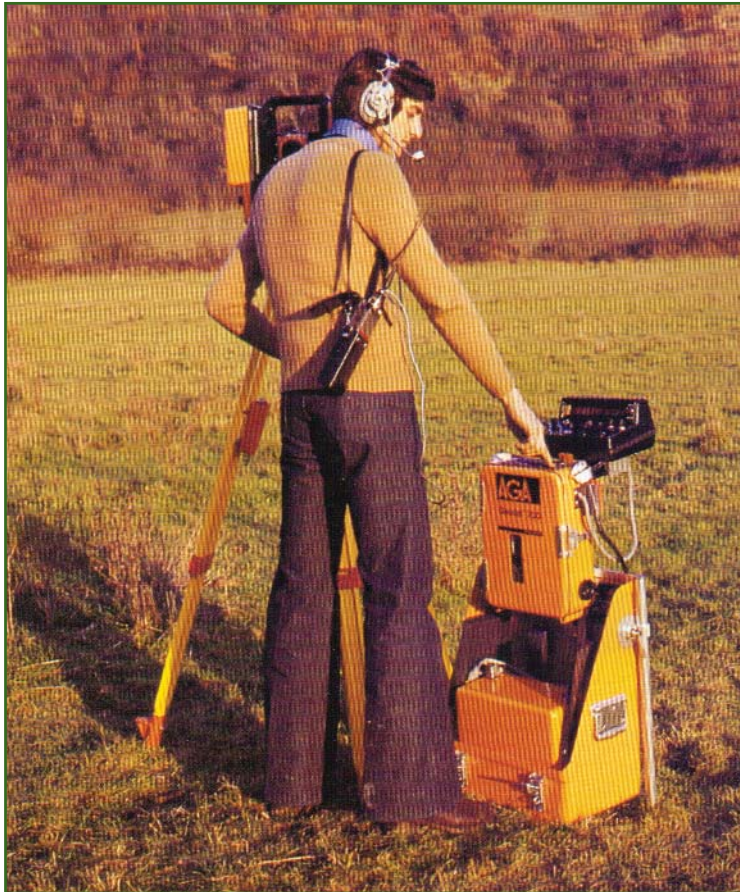
Рис. 4 Измерения с помощью «полной съемочной системы» Geodimeter 700
