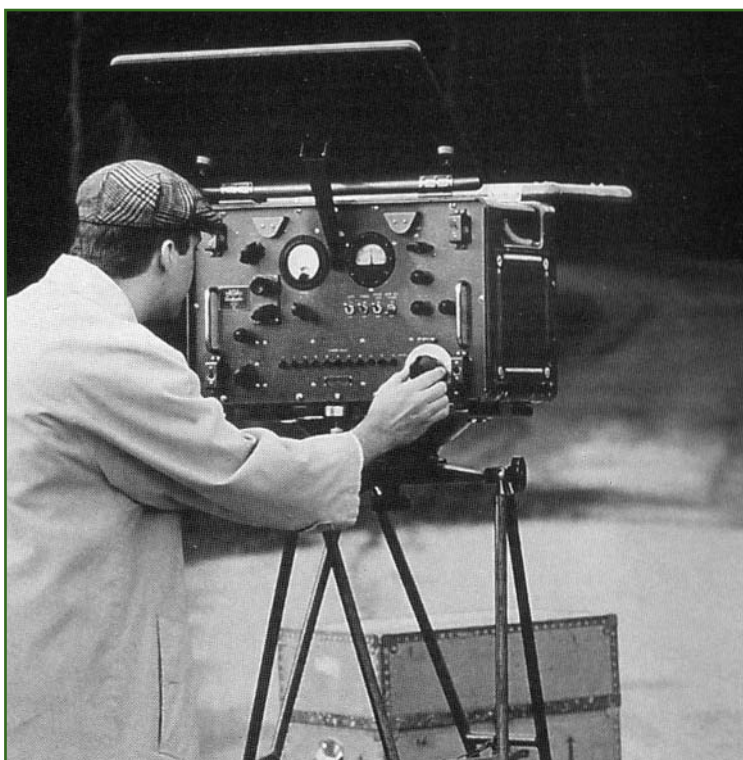
Рис. 1 Светодальномер Geodimeter Model 2 (1955 г.)
