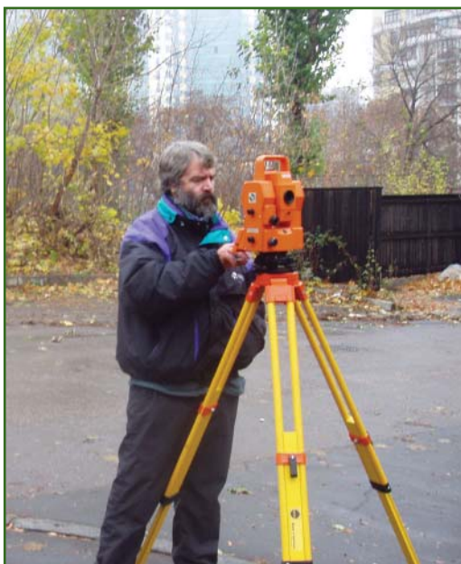
Рис. 9 Электронный тахеометр Geodimeter System 600
