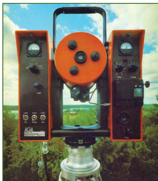
Рис. 3 Одна из модификаций светодальномера Geodimeter Model 6B
