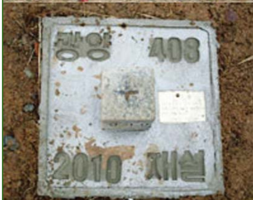
Рис. 5 Типовой пункт триангуляции [5]
