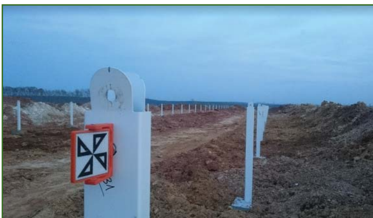
Рис. 4 Отражатель пленочный «Волчок 75» производства MOL'T GEO, закрепленный на опорном столбике
