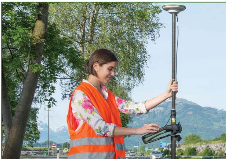
Рис. 2 Leica Zeno 20 с внешней антенной на вехе
