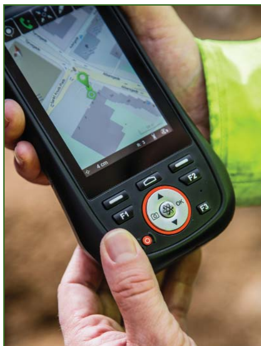
Рис. 3 Отображение на экране местоположения приемника на объекте инвентаризации
