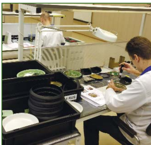
Сборка антенн спутникового приемника инженером АО «ЭОМЗ»
