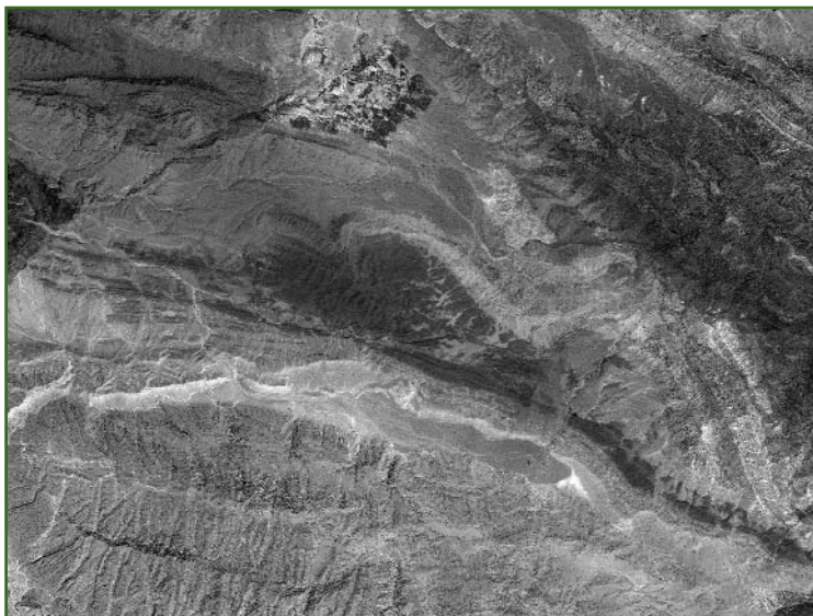
Рис. 1 Фрагмент ортофотоплана с размером пикселя на местности 1,8 м
