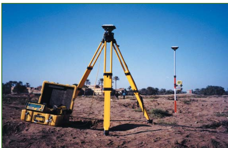
Рис. 1 Базовая станция GPS, установленная на репере
