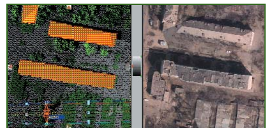
Рис. 4 Пример совместной обработки лазерно-локационных и цифровых аэрофотографических данных (рисунок заимствован из статьи [2])
