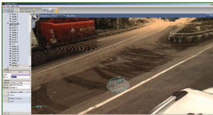
Рис. 3 Виртуальная съемка кромки асфальта в ПО Spatial Factory
