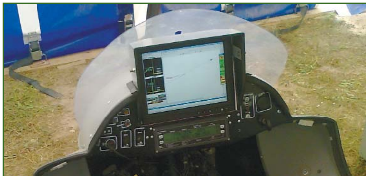
Рис. 4 Приборная панель мотодельтаплана с экраном монитора
