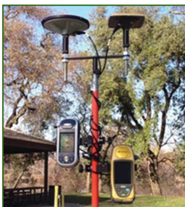
Рис. 4 ProMark220 и приемник другого производителя с антеннами, закрепленные на одной вехе
