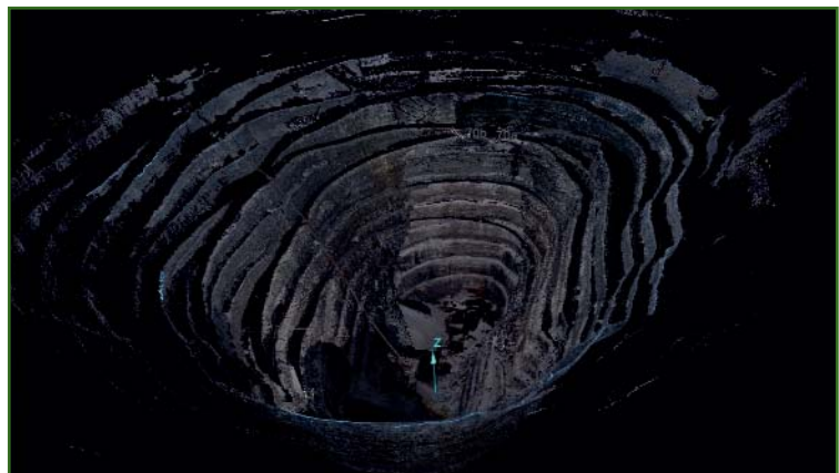
Рис. 3 Результаты лазерного сканирования бортов карьера «Удачный»
