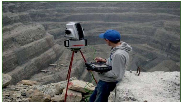
Рис. 2 Сканер Leica HDS 8800, установленный на штативе
