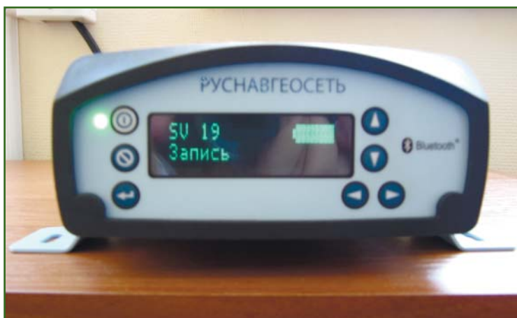
Рис. 1 Инфраструктурный ГНСС-приемник «ФАЗА+»
