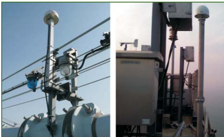
Рис. 4 Контрольные точки с антеннами приемников ГНСС: на тропе канатной системы (слева); на опоре моста (справа)
