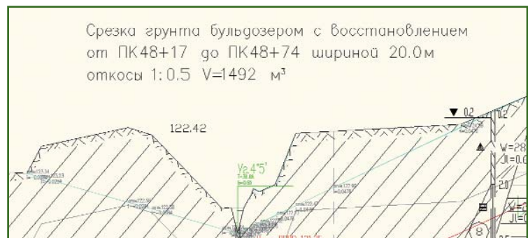
Рис. 6 Расчет объема срезки грунта
