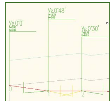
Рис. 5 Наложение тангенсов вертикальных углов на профиль
