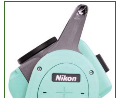
Рис. 3 Визирная ось зрительной трубы электронного тахеометра в положении, близком к зениту
