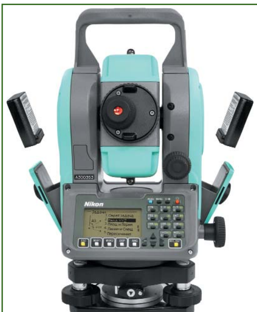
Рис. 4 Размещение аккумуляторов в электронном тахеометре Nikon Nivo
