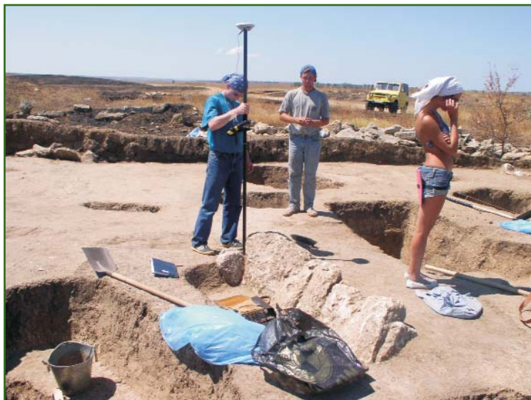
Рис. 2 Съемка с помощью подвижного приемника
