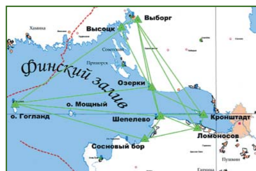
Рис. 2 Спутниковая сеть реперов морских уровенных постов в акватории Финского залива
