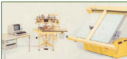
Рис. 2 Фотограмметрический прибор фирмы Kern PG2-GP1 (1960)
