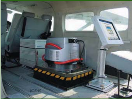
Рис. 8 Цифровая сканирующая аэросъемочная система фирмы Leica Geosystems ADS40 (2001)
