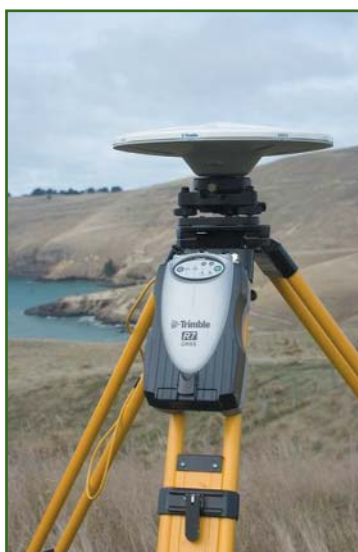
Рис. 1 Комплект оборудования Trimble R7 GNSS, установленный на исходной точке
