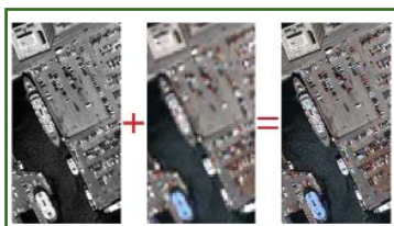
Рис. 6 Пример объединения панхроматического (слева) и мультиспектрального (в центре) изображений
