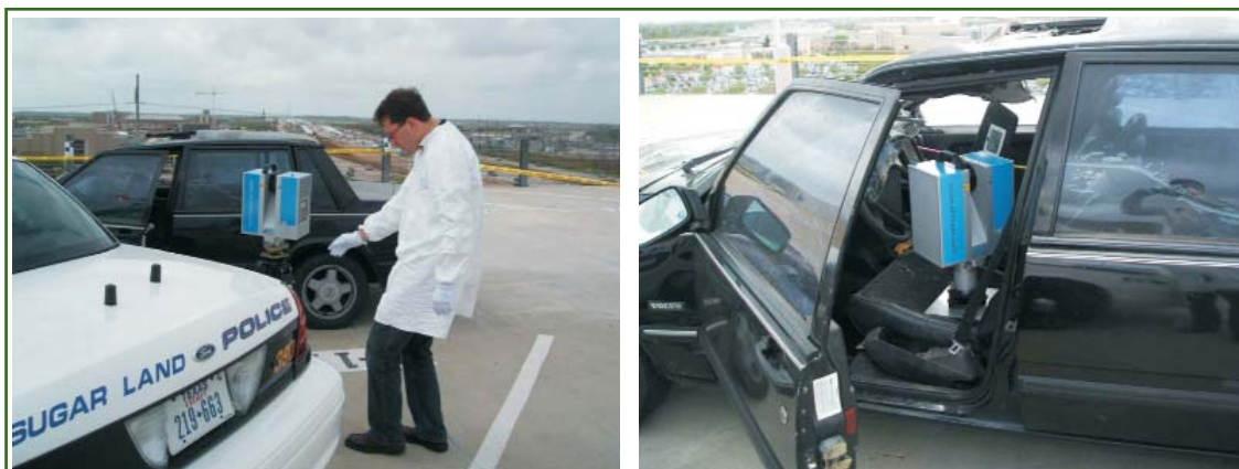
Рис. 2 Измерения с помощью IMAGER 5006 при ДТП
