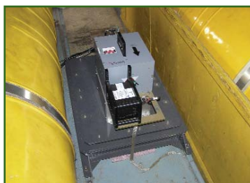
Рис. 1 Сканирующий блок, установленный на самолете
