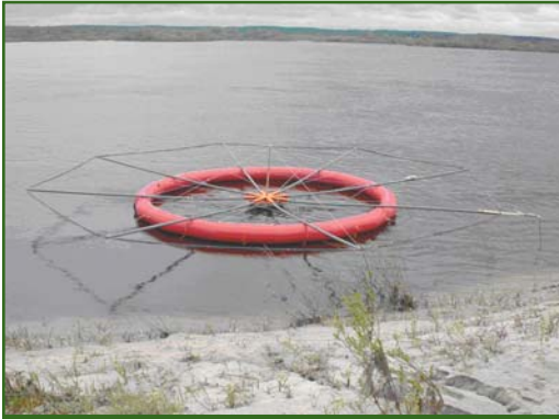
Рис. 1 Соосная генераторно-измерительная установка ЗСБ-МПП
