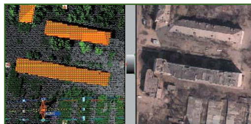
Рис. 4 Пример совместной обработки лазерно-локационных и цифровых аэрофотографических данных (рисунок заимствован из статьи [2])
