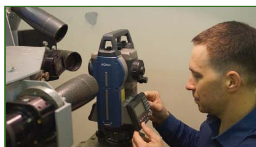
Проверка электронного тахеометра на универсальном автоматизированном коллиматорном стенде VEGA УКС, 2015 г.
