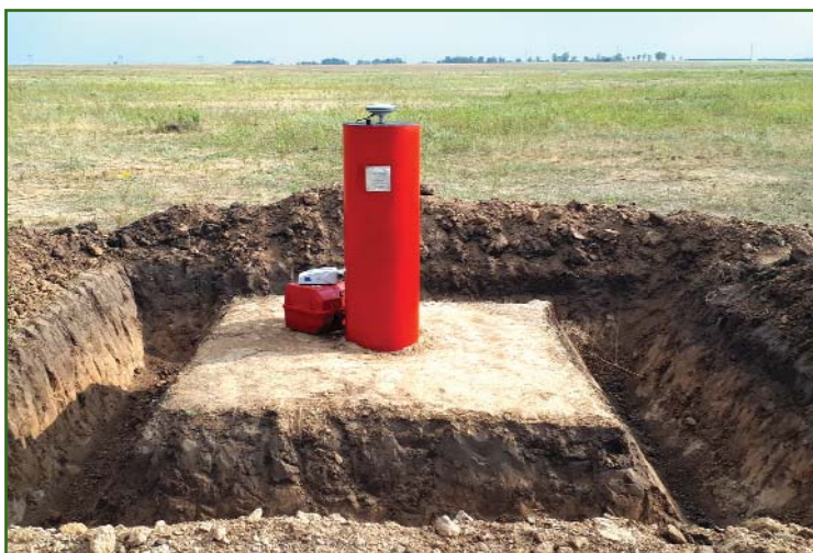
Спутниковые наблюдения на вновь заложеном пункте СГС-1 (Алтайский край), 2020 г.
