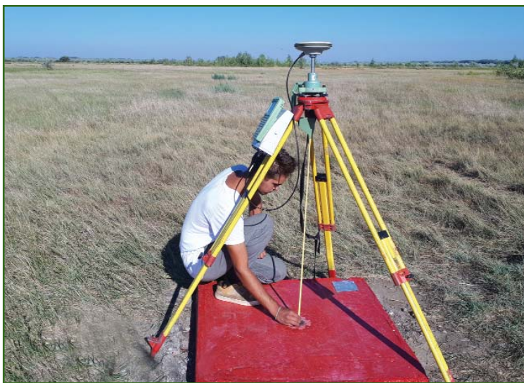
Спутниковые измерения на гравиметрическом пункте (Алтайский край), 2020 г.
