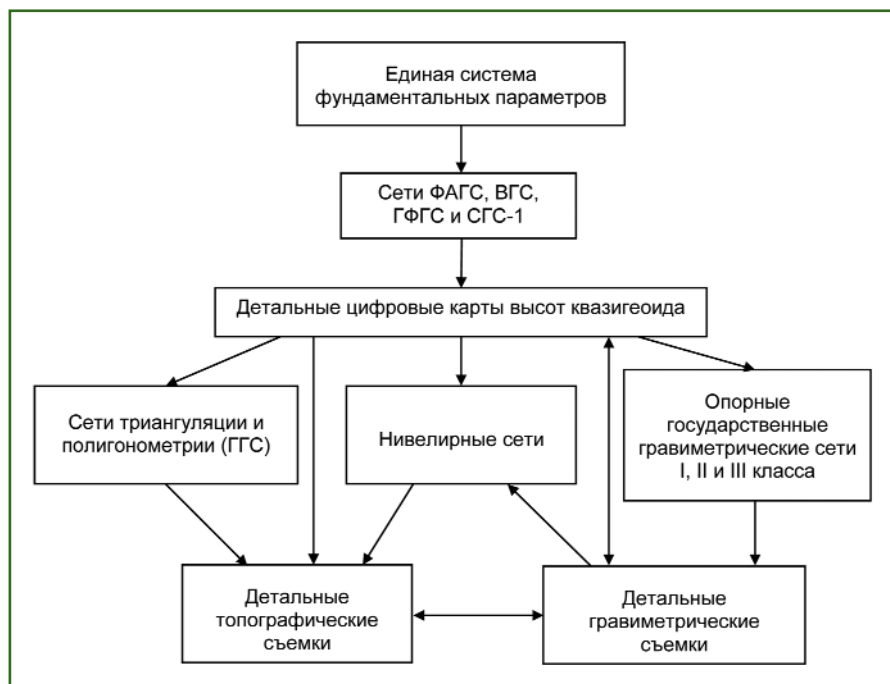
Рис. 2 Новая структура геодезического обеспечения на основе одной системы фундаментальных параметров [8]
