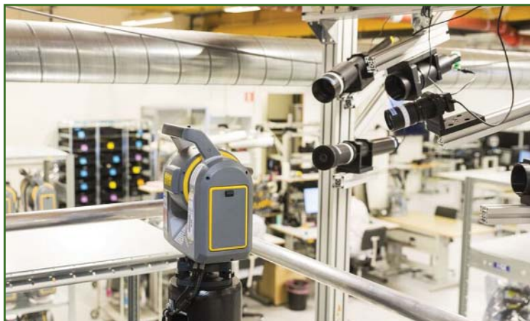
SX10 имеет 5 камер и комбинацию лазеров и датчиков, которые команда инженеров назвала «3DM». Сложность прибора потребовала разработки нового сборочного, наладочного и испытательного оборудования ( www.xyht.com )
