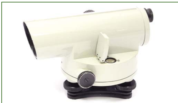
Рис. 30 Нивелир НЗК с компенсатором и внутренней фокусировкой. СССР, Харьковский завод точного приборостроения «Точприбор», 1987 г.
