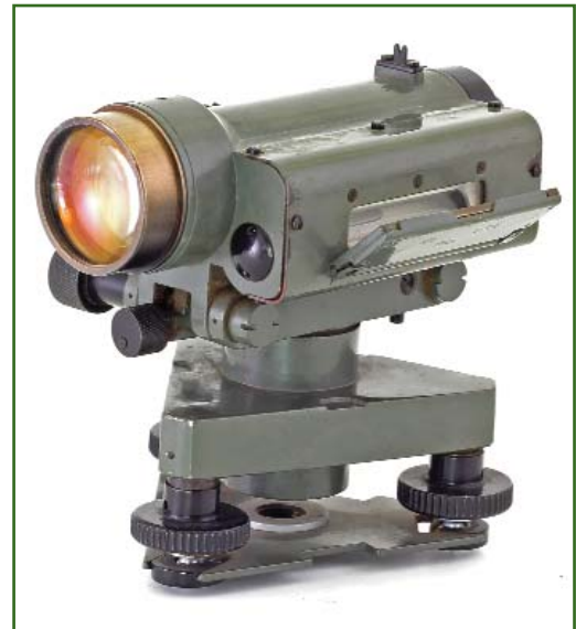
Рис. 25 Нивелир НВ-1. СССР, Изюм, Приборостроительный завод, 1962 г.
