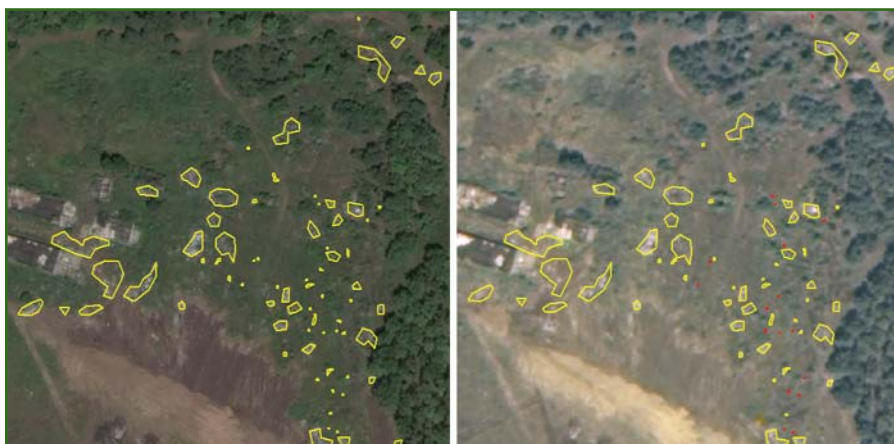
Рис. 3 Сравнение возможностей выявления мест складирования отходов для снимков с КА GeoEye-1 (слева) и с КА «Ресурс-П» (справа). Выявленные места обозначены желтым цветом, «пропущенные» — красным цветом
