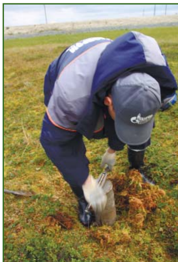
Рис. 5 Исследование почвенного покрова — отбор пробы (фото Е.Е. Ильяковой, ООО «Газпром ВНИИГАЗ»)
