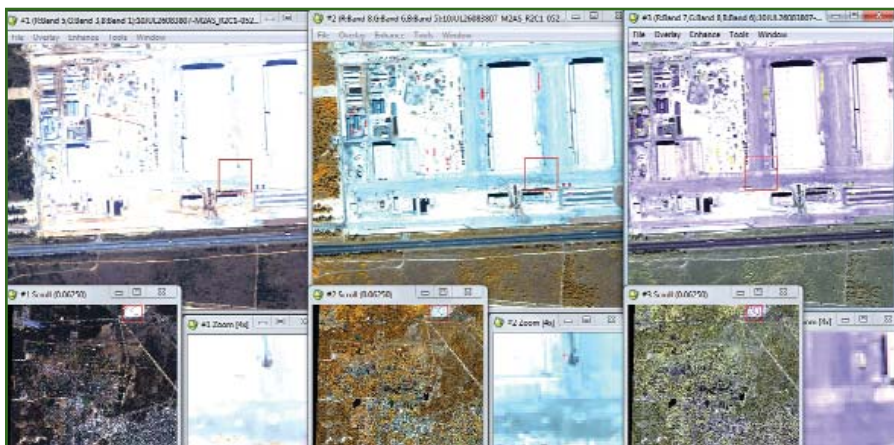
Рис. 4 Использование комбинаций различных спектральных диапазонов для увеличения информативности снимка и качества распознавания отдельных объектов
