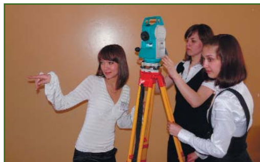
Рис. 2 Определение неприступного расстояния электронным тахеометром
