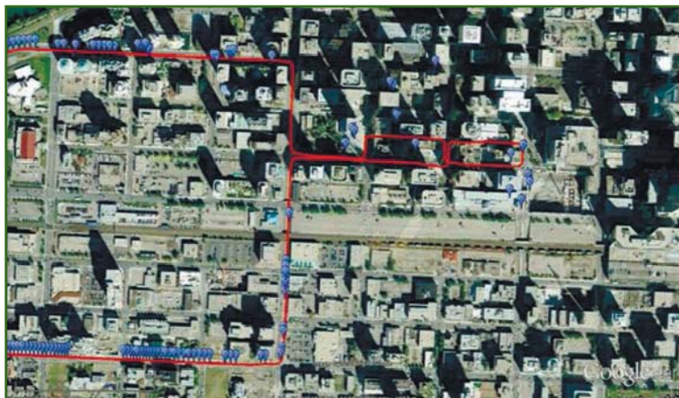
Рис. 4 Траектория движения по данным навигационного комплекса с использованием ВОГ
