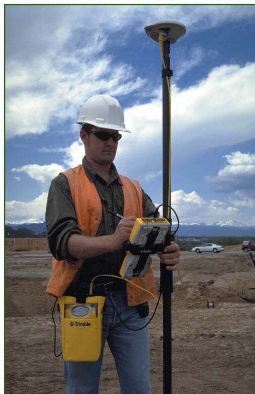
Рис. 2 Двухчастотный спутниковый приемник GPS Trimble 5700
