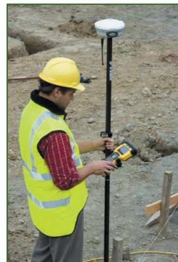
Рис. 1 Вынос проекта в натуру в режиме RTK
