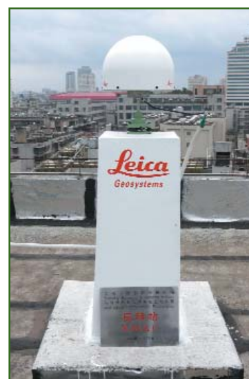
Рис. 2 Крепление антенны спутникового приемника на железобетонном пилоне
