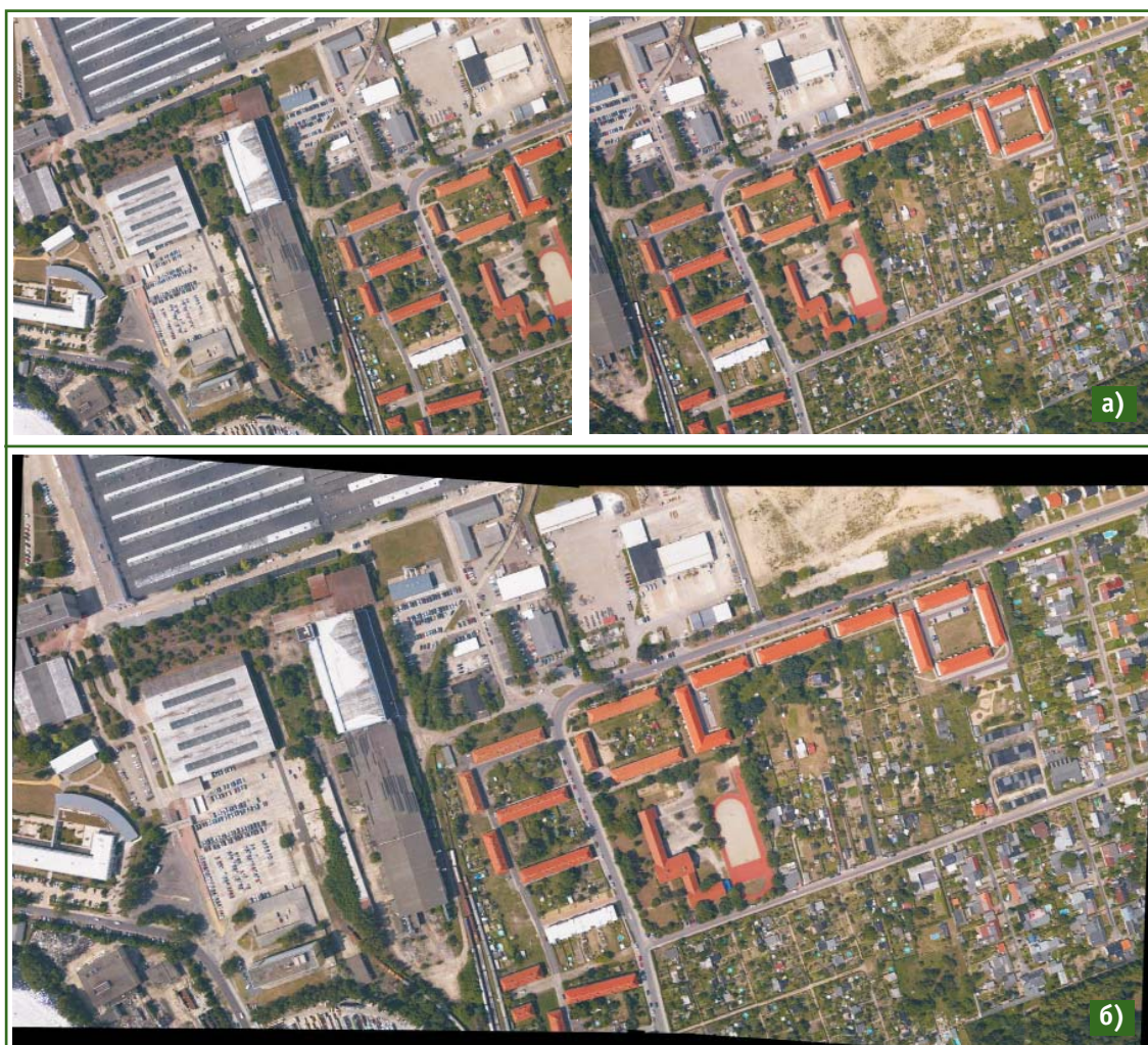
Рис. 4 Пример получения цифрового аэрофотоснимка при конфигурации «синхронное срабатывание»: а) синхронные снимки, полученные каждой камерой при перекрытии 50%; б) результирующий снимок после автоматической обработки
