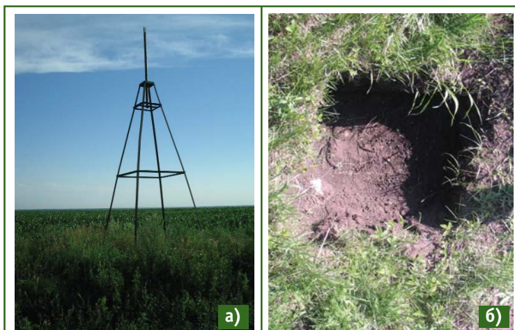
Рис. 2 Пункт ГГС с металлической пирамидой (а) и центром (б)
