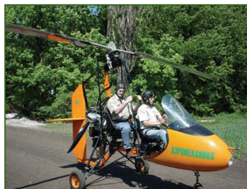
Рис. 1 Двухместный автожир АМ-1 для аэросъемки
