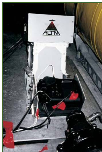
Рис. 1 Размещение аэросъемочной аппаратуры внутри фюзеляжа вертолета Ми-8
