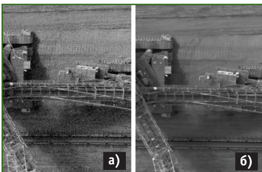
Рис. 3 Фрагмент аэрофотоснимка: а) съемка с помощью Leica Geosystems RC-30; б) съемка с помощью Vexcel UltraCAM-D
