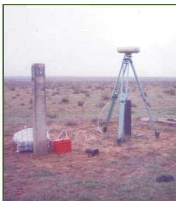
Рис. 5 Спутниковая антенна, установленная над геодезическим пунктом
