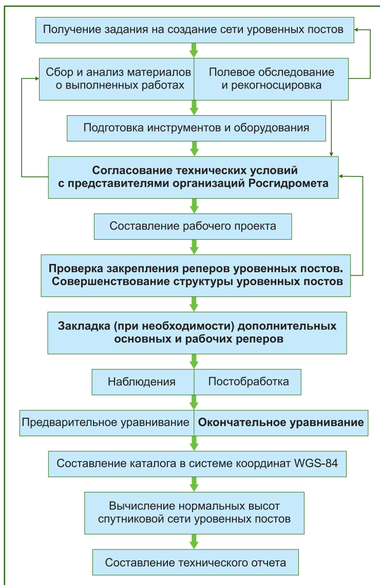
Рис. 1 Технологическая схема создания спутниковой сети уровенных постов
